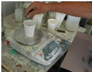
A: 塗膜は完全に乾燥させて重量を 0.1g の単位まで量ります。20g 前後の重量になるような量にします。
