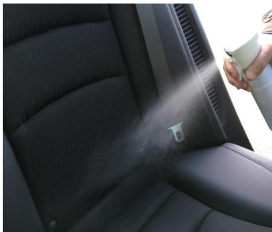
噴射ガスとともに封入するエアゾール方式は危険物として輸送や保管に制限がある上、金属缶の腐食の点で貯蔵安定性にも不安がありますが、最新型の蓄圧式スプレー容器を採用して問題がすべて解決しかたんでキレイなスプレー施工が可能になりました。ミストも細かく、エアゾールに遜色ありません。早々にローンチカスタマー向けに製品として発売します。
