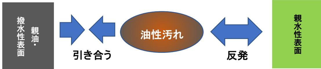
洗い流すという工程を経なくても表面を親水性にするだけで油性汚染物質の付着は防止できます。実際当社では屋外曝露試験（右図）をすべて水平状態にして実施していますが垂直はもとより45° 傾斜に比べても格段にシャープな汚染の違いが確認できてい
