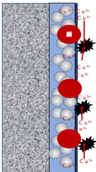
NFE2は光触媒が発生する活性酸素が直接RNA/DNAを破壊するのではなく光触媒の超親水性により発生する銅イオン $Cu^{2+}$ がそれらを無力化するという方式で殺菌・抗ウイルス機能を発現していますので反応は迅速ですが人体への悪影響がない、という特長があります。
