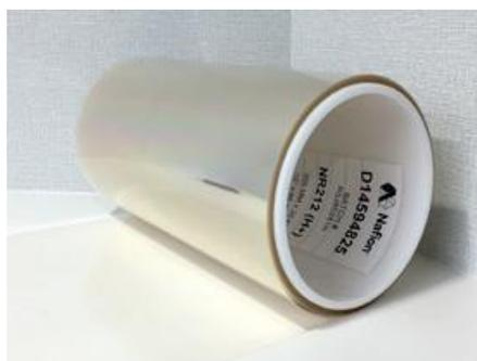
この隔壁の厚みは通常  $20\mu\text{m}$  以上とされています。つまりこの厚みの Nafion 膜(フィルム)は完全に  $\text{Cl}^-$  の透過を遮断することができる証拠となっています。ただ、これは建物の表面に形成させるには金箔を張り付けるほど高価なものになり建築分野で採用するには実用的とはいえません。
