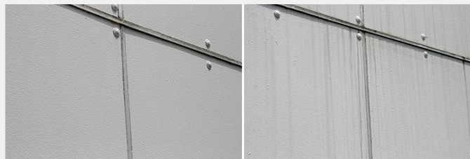
図2 光触媒塗料(左)と一般的な塗料(右)の防汚効果比較(2年5か月曝露後の表面)
